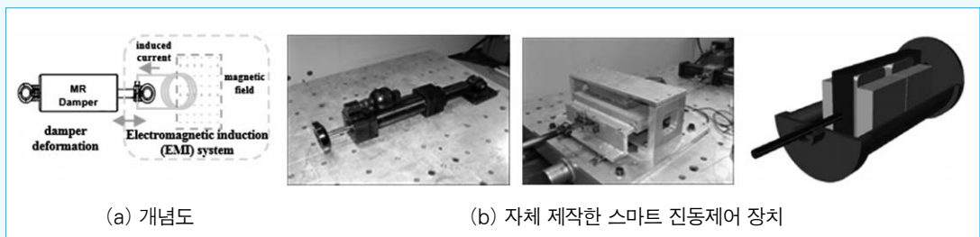
그림 1 MR 유체 댐퍼와 전자기유도부가 결합된 스마트 진동제어 장치
